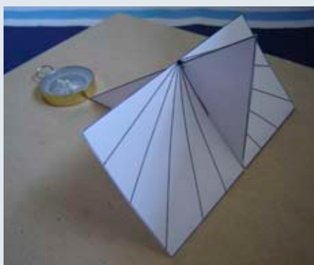
Figura 4. Reloj de sol ecuatorial listo para usar (izquierda). El gnomon debe alinearse en la dirección norte-sur, con su parte más alta apuntando al polo sur celeste, disposición que vale para el hemisferio sur. La brújula que se ve a la izquierda está, en consecuencia, del lado norte. El tablero tiene las líneas horarias y su plano es paralelo al del ecuador. La imagen de la derecha muestra el reloj visto de arriba, mirando con visuales paralelas al plano del ecuador, que revelan el tablero y el gnomon de canto.
