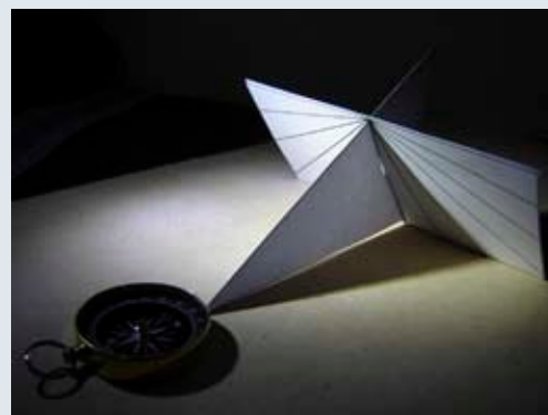
Figura 5. Lectura de las horas en el reloj de sol ecuatorial. La imagen de la izquierda muestra la situación durante los meses de primavera y verano, cuando el Sol se desplaza siempre por encima del plano del tablero. La imagen de la derecha muestra lo que sucede durante otoño e invierno, cuando el Sol ilumina siempre la cara inferior del tablero. Durante los equinoccios el Sol se desplaza en un plano que coincide con el del tablero, y por ello el reloj ecuatorial que se muestra no proporciona sombras útiles para saber la hora. En ambas imágenes se muestran sombras matutinas (a eso de las 10) en el hemisferio sur.
