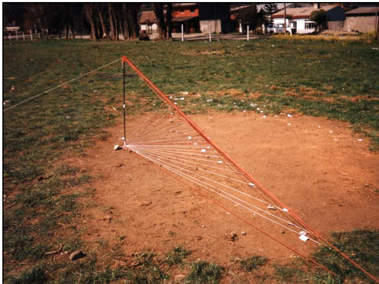
El gnomon y la estructura de hilos en el espacio tridimensional durante un equinoccio.
