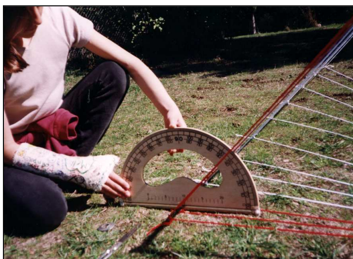
Medición directa del valor de la co-latitud (altura angular del Sol)
