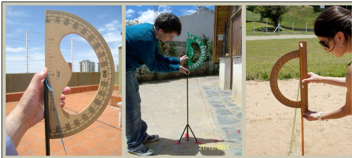
Figura 3: Medición del ángulo que los “hilos de luz” forman con la vertical astronómica del lugar, materializada por el gnomon, a mediodía solar verdadero. Este ángulo es complementario de la altura angular del Sol sobre el horizonte en su culminación superior. Fotos de Buenos Aires, Esquel y Caxias do Sul.
