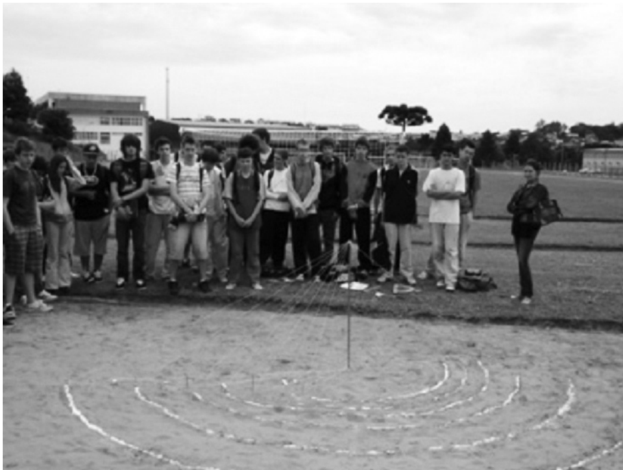
El método de las alturas iguales para determinar la línea NS, en Caxias do Sul (arriba) y en Buenos Aires (página siguiente).
