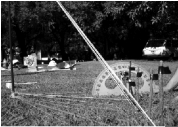
Medición del ángulo de la latitud en San Bernardo do Campo. Medición del ángulo de la co-latitud en Bs. As.
