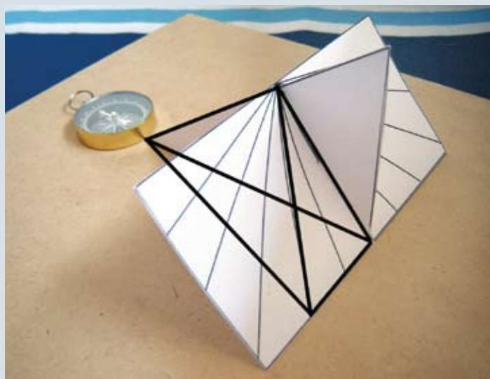
**Figura 5.** Nueva imagen del reloj de sol ecuatorial de la figura 1 en la que se destacan las dos piezas ensambladas que componen el instrumento: el gnomon vertical (CFM) y el tablero inclinado (BPLT). Adviértase que la parte más clara del primero solo se vería si el segundo fuera transparente.
