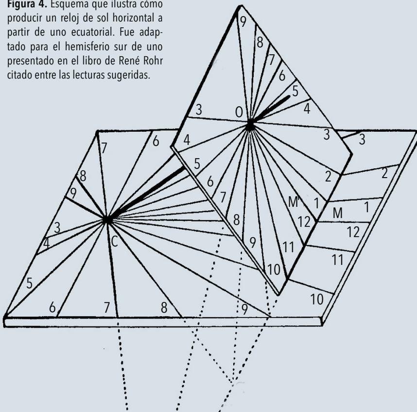
ejemplo, antes de las 9 de la mañana. En particular, la línea de las 6 de la mañana del reloj ecuatorial es paralela al plano horizontal (o lo toca en el infinito). Lo mismo sucede con la de las 6 de la tarde. Por ello es útil recurrir a un método analítico para realizar mediante unos pocos cálculos el trazado de las líneas. El que presentaremos quizá sea menos directo e intuitivo, pero no tiene esas limitaciones.
