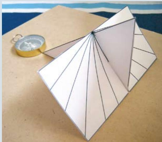
**Figura 1.** Reloj de sol ecuatorial para una latitud intermedia del hemisferio sur a ser construido en el aula, según lo explicó una nota anterior nuestra en CIENCIA HOY citada entre las lecturas sugeridas. El gnomon -triángulo vertical de cartón- está alineado en dirección norte-sur, como lo muestra la brújula colocada en su extremo norte. La diagonal o hipotenusa del gnomon apunta al polo sur celeste. El tablero o cuadrante contiene las líneas horarias y está en el plano del ecuador.
