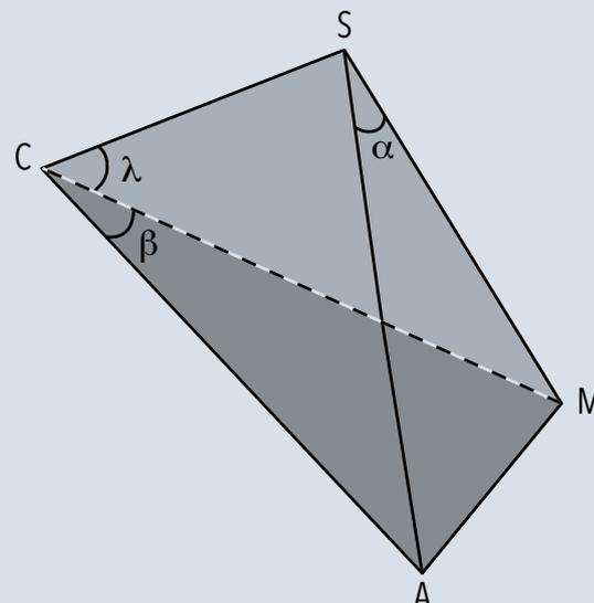
**Figura 7.** Esquema de la estructura tridimensional formada por el triángulo rectángulo CMA, perteneciente al tablero del reloj de sol horizontal, el igualmente rectángulo SMA, del tablero del reloj ecuatorial, y el CSM, que está en el plano vertical del gnomon. El segmento CS es parte de la hipotenusa o diagonal del gnomon. CM es la línea del mediodía del reloj horizontal; SM es la misma línea del reloj ecuatorial.
