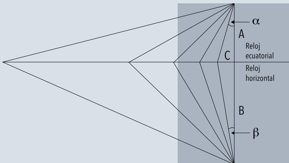
**Figura 9.** Conociendo las dimensiones del tablero del reloj ecuatorial (rectángulo agrisado superior) y la fórmula que relaciona  $\beta$  con  $\alpha$  para determinada latitud, es posible deducir la longitud del tablero del reloj horizontal. En este esquema, C es un pequeño segmento compartido por ambos tableros y cateto opuesto a los ángulos  $\alpha$  y  $\beta$  de los dos triángulos rectángulos mostrados.
