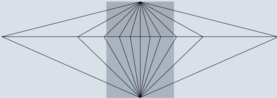
**Figura 8.** Esquema útil para diseñar el tablero de un reloj horizontal (rectángulo agrisado inferior) a partir del tablero de un reloj ecuatorial (rectángulo agrisado superior) como el representado en la figura 4.
