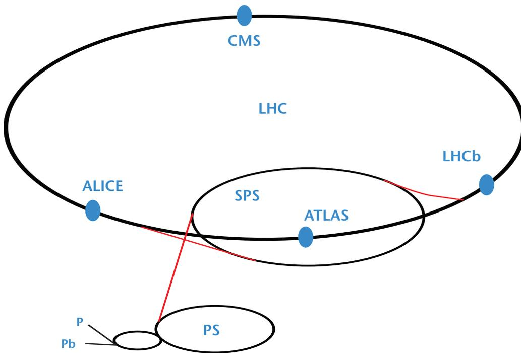
Áreas experimentales del gran colisionador de hadrones. La trayectoria de los protones comienza en los aceleradores lineales (en P y Pb). Continúa su recorrido en el sincrotrón de protones (PS), en el super sincrotrón de protones (SPS) y finalmente se los hace ingresar en el túnel de 27km de largo del gran colisionador de hadrones. En el anillo principal hay cuatro detectores de partículas resultantes de colisiones, marcados con puntos azules. Wikipedia commons. Autor: Arpad Horvath
